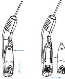
2. Desconecte a bateria a ser substituída:
