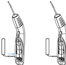
4. Posicione o conector e seus fios no compartimento da bateria, de modo que estes fiquem devidamente acomodados em seu interior, não obstruindo o conector USB ou impedindo o fechamento da tampa:
